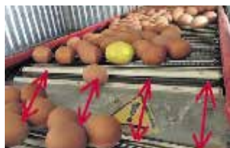
Фото 6. Переход между транспортерами
