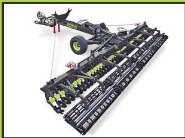
Борона дисковая двухрядная прицепная БДП шириной захвата 4, 5, 7 и 10 м (диск диаметром 430 мм)
