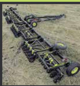
Катки кольчато-шпоровые и кольчато-зубчатые шириной захвата от 6 до 18 м.
