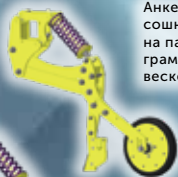
Колесо прикатывающее с шиной атмосферного давления 320x50
