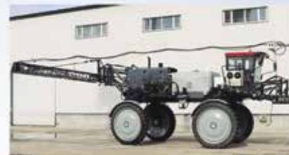
ЗWPYZ -3000-240, Китай, гидроход, двигатель 240 л.с., бак 4000 л, клиренс 200см, штанга 28 м, колея 280 -360 см, подсветка, автопилот, система Агронавигатор
