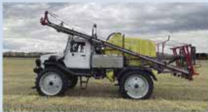
ОШ-ВД-СВ Садко-Классик, базовое шасси ГАЗ-33088 бак 3000 л, клиренс 82 см, штанга до 30 м, подсветка, гидравлический автопилот, система Агронавигатор
