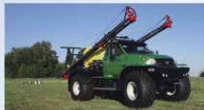
ОШ-ВД-С Российский Фермер, шасси УАЗ, ГАЗ, ЗИЛ, КАМАЗ бак 1000/3000/4000/5000 л, клиренс а/м носителя, штанга до 30 м, подсветка, автопилот, система Агронавигатор
