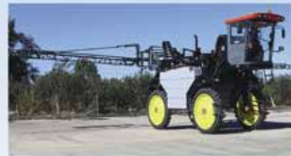
ЗWPYZ -3000-175, Китай, гидроход, двигатель 175 л.с., бак 2x1500 л, клиренс 210см, штанга 28 м, колея 220-280 см, подсветка, автопилот, система Агронавигатор
