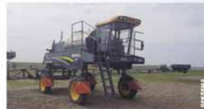
3W PZ-4000GX2, Китай, механика 2 WD, двигатель 140 л.с., бак 4000 л, клиренс 150 см, штанга 24 м, колея 280 см, подсветка, автопилот, система Агронавигатор
